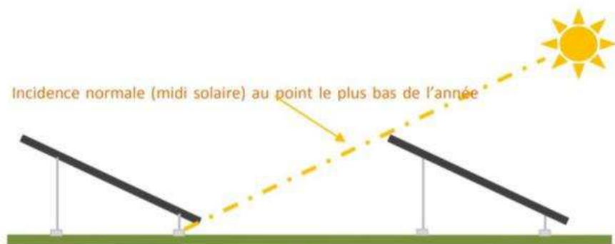
Figure 8 : Principe d'espacement des rangées en fonction du soleil
