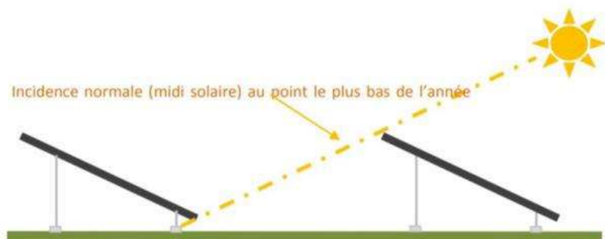
Figure 8 : Principe d'espacement des rangées en fonction du soleil
