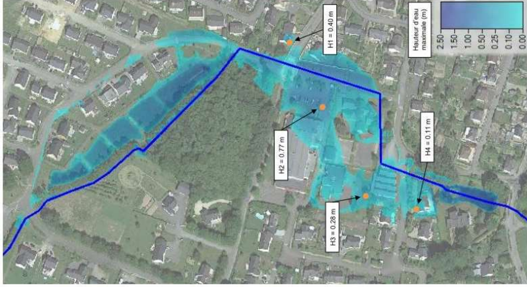
Figure 8: modélisation du débordement en cas de période de retour 100 ans, avant aménagement
