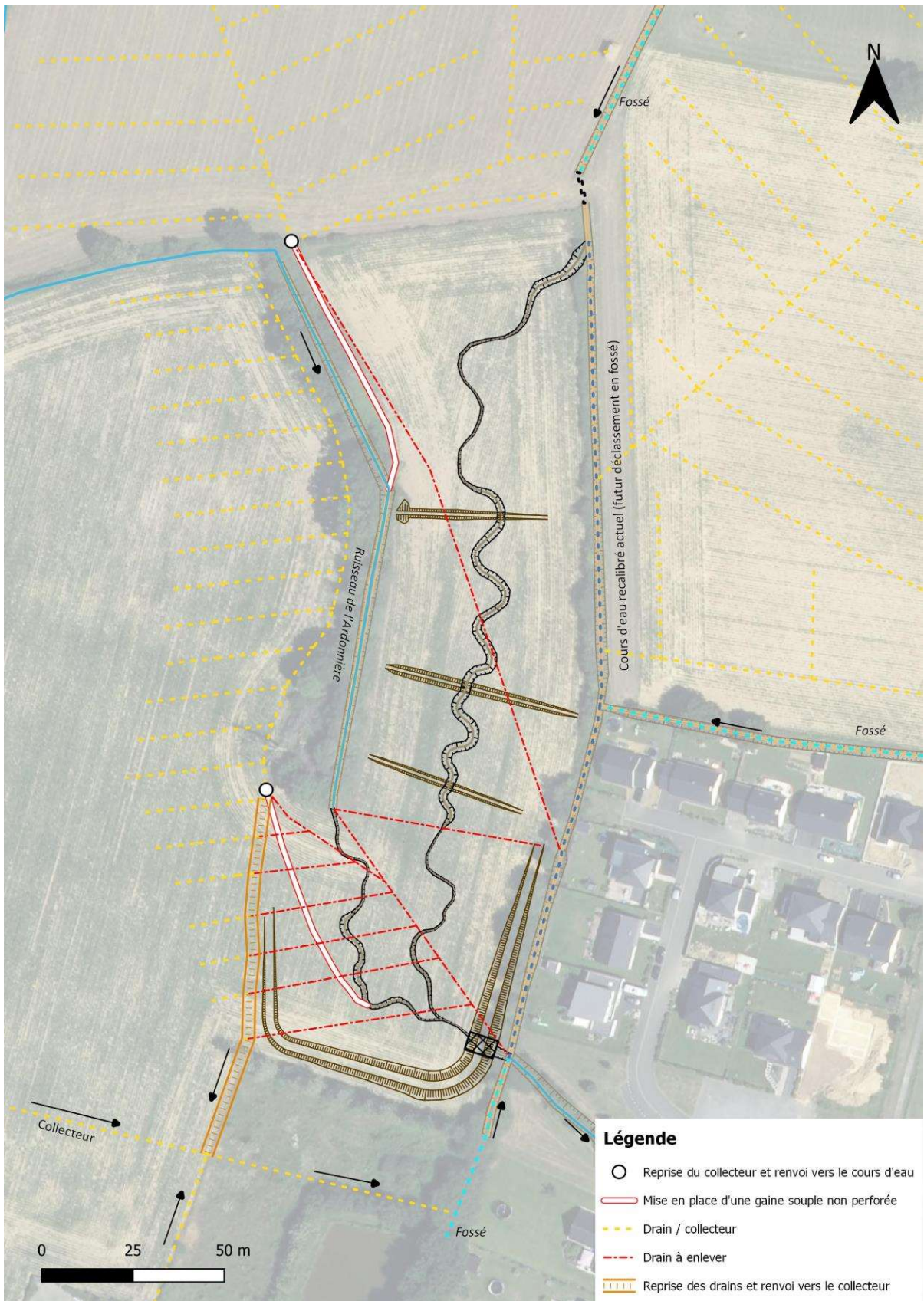
Carte 14: cartographie des reprises de drains et des exutoires sur la parcelle
